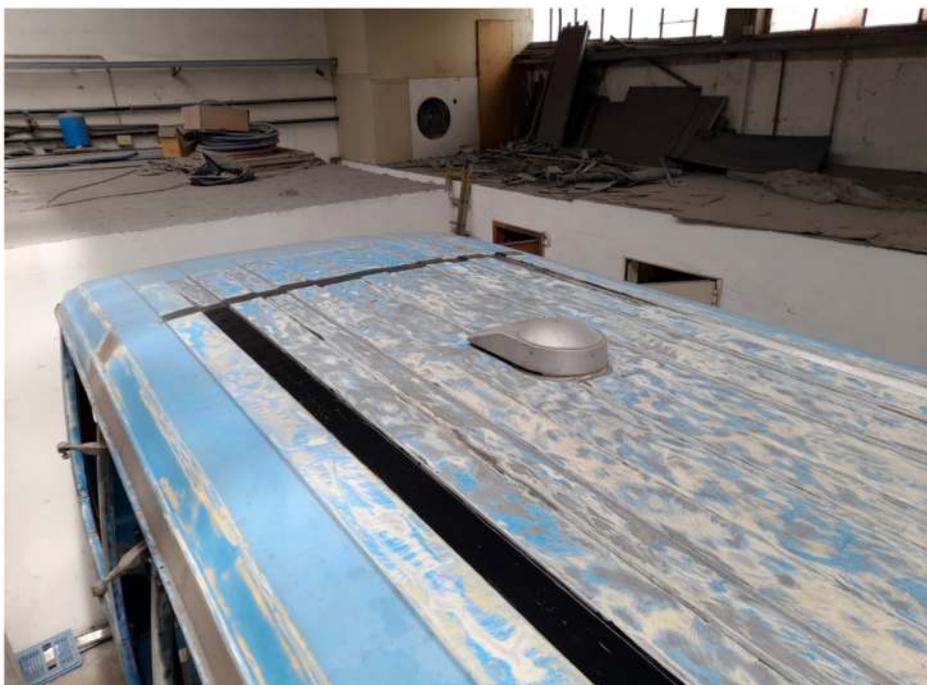
**A lato: le varie fasi del risanamento del bus; il tetto viene ripulito dalla vecchia vernice. Sotto: la stuccatura basale di tutta la carrozzeria. In basso: Fedor completa il fissaggio della nuova lamiera dell'angolo posteriore destro.**
